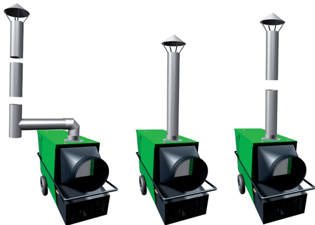
Eksempel 1 Drift med forlenget avgassrør. Kondensfelle påkrevd
